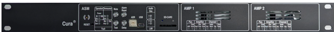
Frontansicht CuraG3 Grundgerät – 2 Verstärker 250 W
